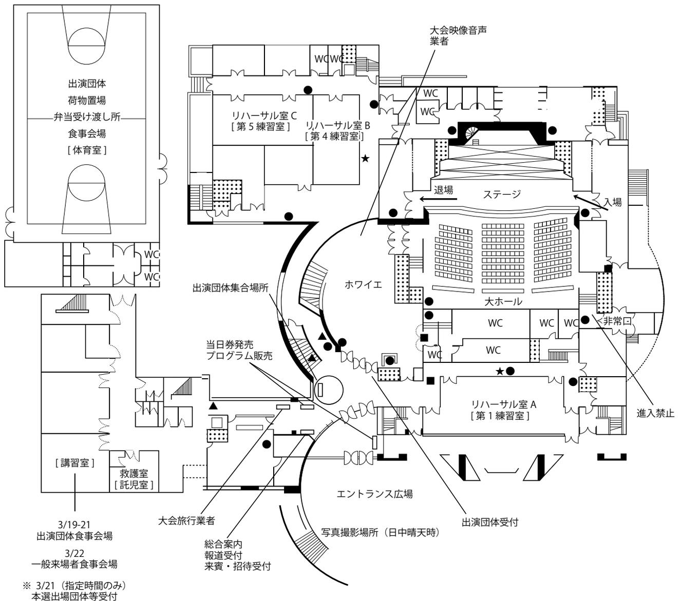
●消火器 ★消化栓 ▲防火シャッター手動閉鎖装置 ■防火扉
